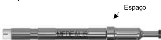
A seguir, a ponta é inserida na vertical no inserto de retenção no invólucro da matriz. O inserto de retenção é removido do invólucro da matriz com uma ligeira inclinação. As arestas vivas da ponta seguram o inserto de retenção com firmeza na ponta. Enroscando a ponta no sentido contrário ao dos ponteiros do relógio no elemento central, o pino de libertação na ponta é empurrado para a frente e solta o inserto de retenção da ponta.
